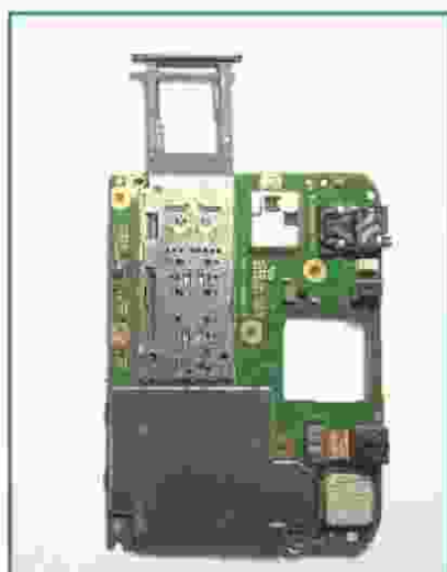
Figura 3.6. Detalle de tarjeta porta SIM con sensor de ID de bandeja.
