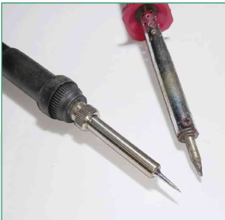
Figura 4.5. La suciedad y el carbón forman una película que evita la transferencia térmica del cautín al estaño. Mantén tu soldador limpio para evitar problemas.
