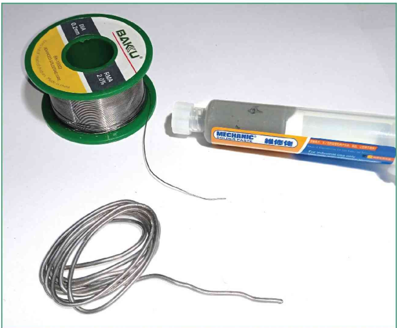
Figura 4.4. Para las reparaciones puedes utilizar estaño en alambre de diferente diámetro, así como estaño en pasta, para facilitar su aplicación.
