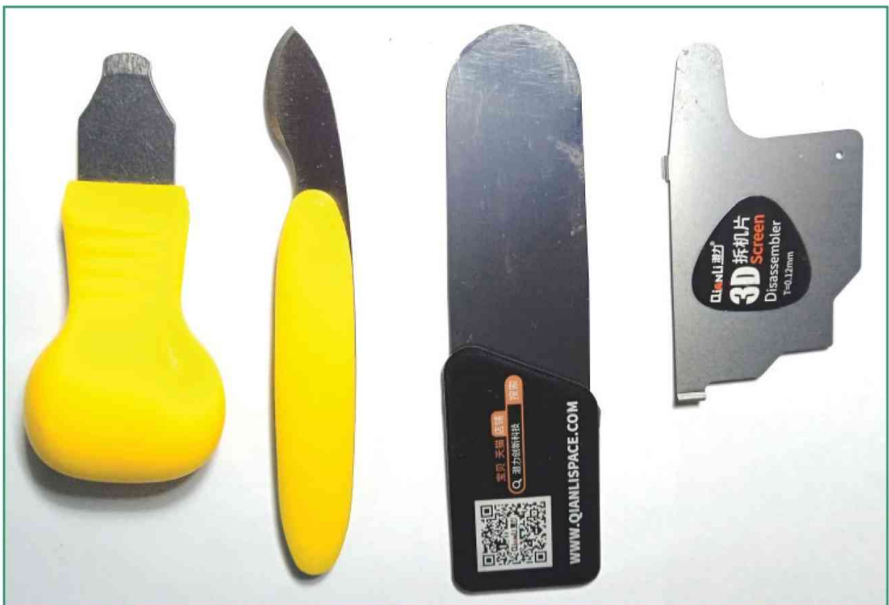
Figura 2.5. Para abrir pantallas y tapas traseras, debes conseguir herramientas de apertura lo más planas posible. Hay algunas en el mercado que están basadas en láminas de metal flexible.
