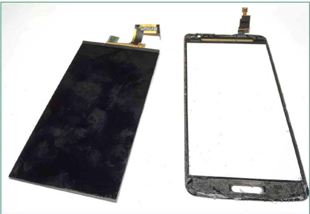
Figura 2.1. A la izquierda, una pantalla con sus conectores Flex; a la derecha, un táctil de acrílico que cumple la función de proteger la pantalla y, a su vez, de leer la información de los dedos sobre ella, ambas piezas se conectan a la placa madre.
