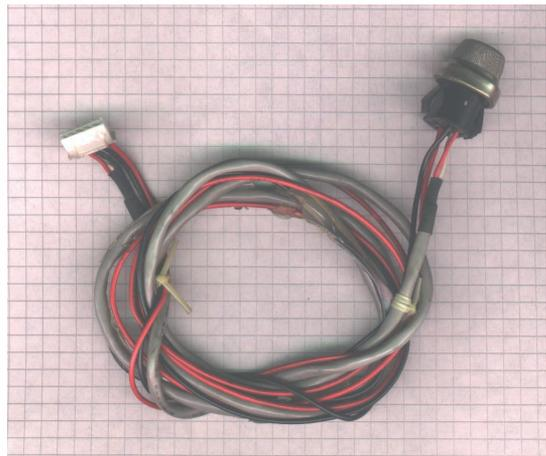
**Figura 2 - Sensor gaseoso con manguera de cable y conector**
