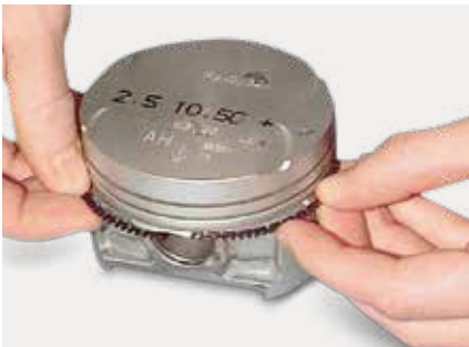
1. El muelle expansor se ajusta en la ranura.
