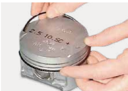
2. Girar la lámina inferior 120° con respecto a la hendidura del segmento.
