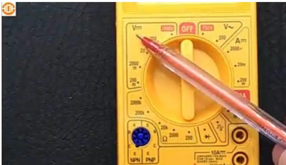
Ahora pasemos a la parte de voltaje pero de alterna, que está para el lado derecho y vemos que nos dice 750V y no dice 200V, el voltaje alterno aquí no lo está diciendo la forma como de una S
