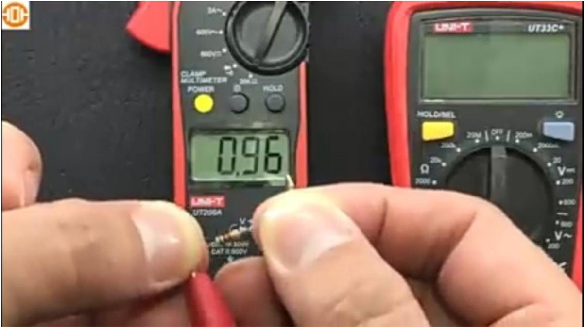
Ahora si lo ponemos en voltaje DC tenemos una batería y vamos a ver cómo nos mide con el voltaje DC tiene una precisión muy baja porque está en el rango de los 600 ese sería una desventaja porque si nosotros vamos a trabajar con voltajes muy bajos por ejemplo de 6V lo ideal no sería hacerlo con este multímetro sería hacerlo con el anterior, pero yo le muestro para que ustedes vean que sí lo mide pero con una precisión muy deficiente entonces si mide voltaje DC pero con baja precisión.
