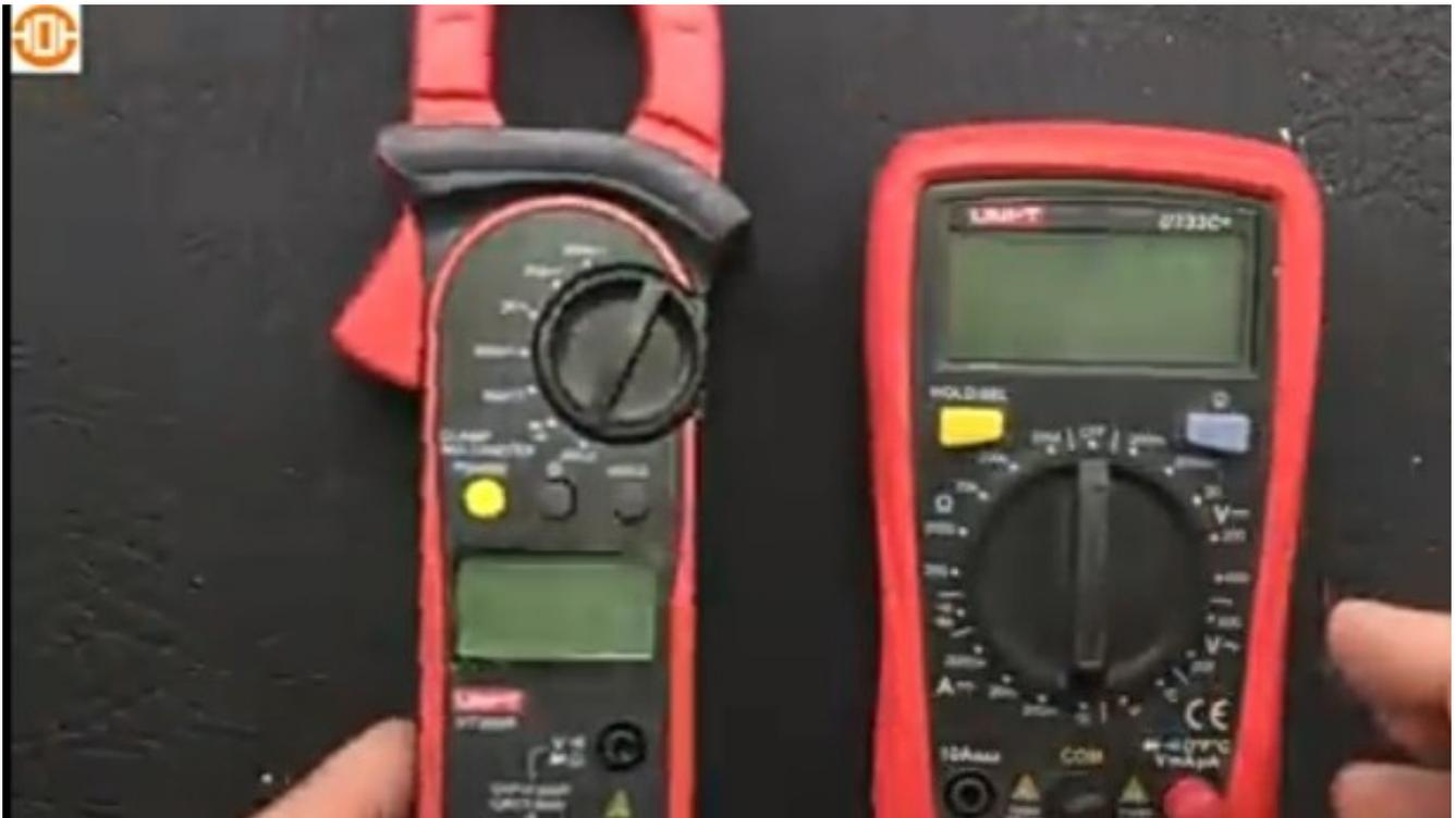
Ahora analizando este multímetro vamos a irnos a la parte superior, vamos a empezar desde la parte inferior para ohmio (20 k), luego podemos medir igual que en el anterior diodos y la continuidad,
