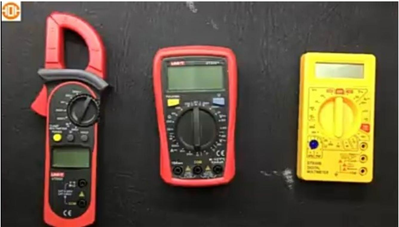
➤ Entonces comencemos con el más básico, vamos a revisar toda sus partes, el primero es llamado multímetro digital porque muestra los resultados de forma digital en la pantalla y tiene un selector que tiene una flecha que nos indica la opción que está siendo seleccionada entonces al observarlo vemos que la opción que está seleccionada es OFF (apagado).
