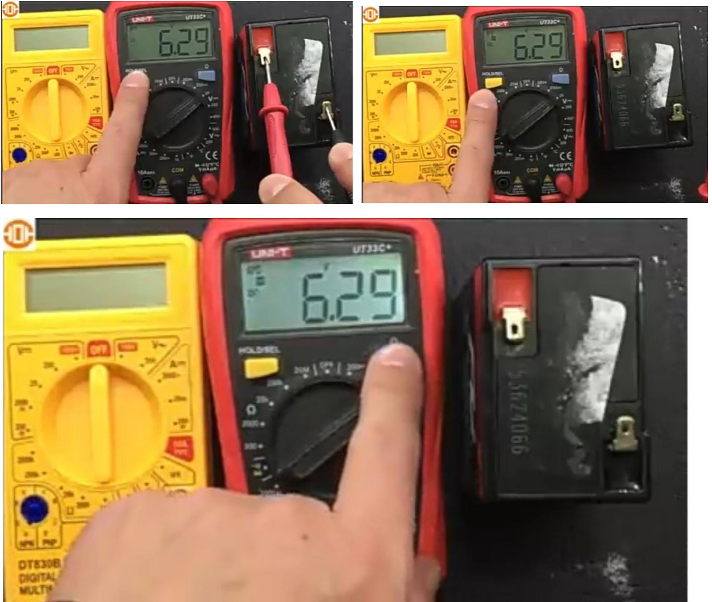
Al probar la parte de la continuidad que no va a producir un sonido entonces lo ponemos en la medición y se juntan las puntas y se pone en cero y no marca produciendo un sonido, si nosotros quisiéramos probar por ejemplo si un fusible térmico está bueno se escucha el pitido que hace, da igual si lo hago por un lado o el otro, eso me indica que está.
